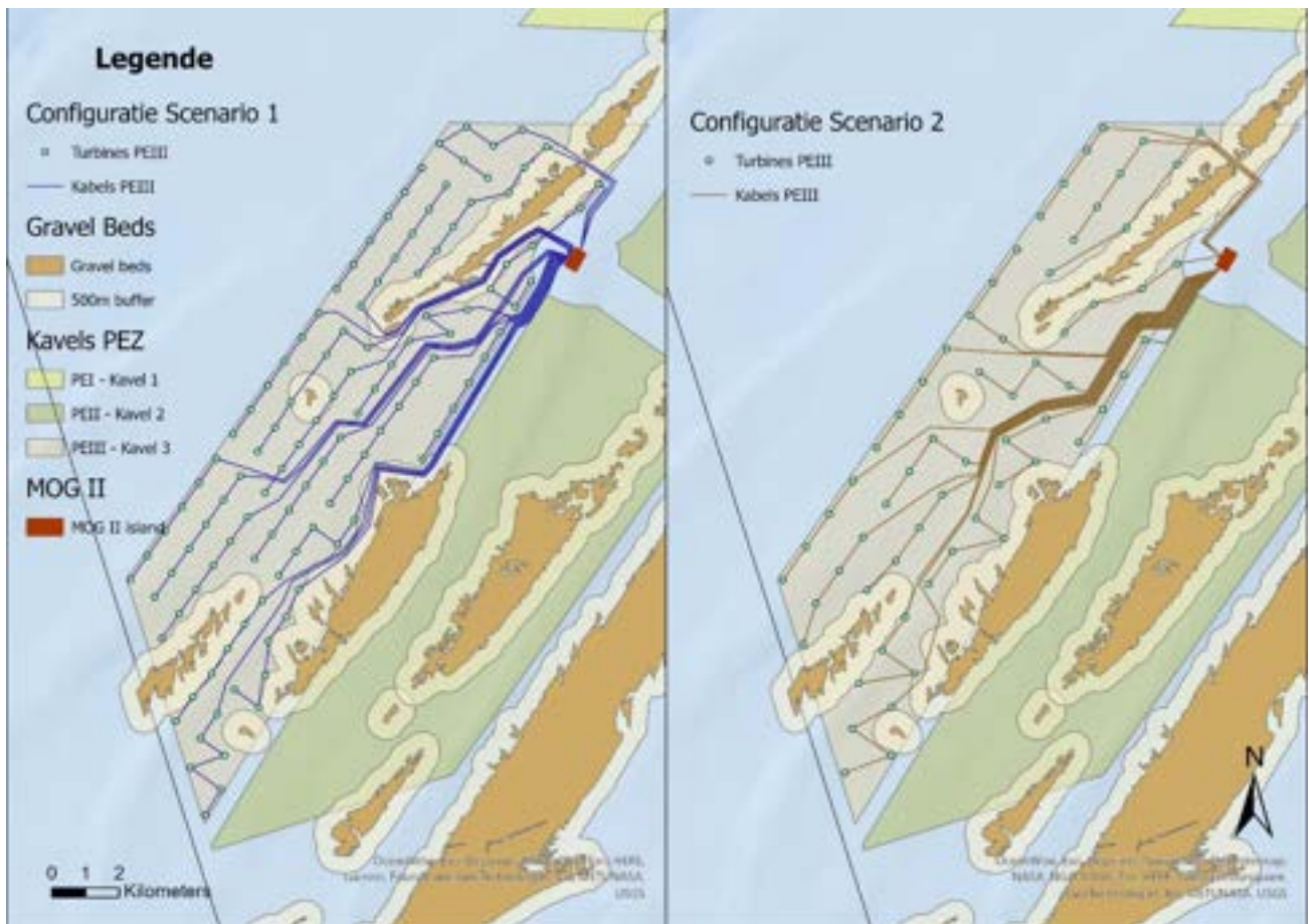
Figuur 7-4 – Indicatieve intekening van een concept-configuratie voor zowel turbines als parkbekabeling voor scenario 1 (linkerpaneel) en scenario 2 (rechterpaneel) in kavel PE II. Het MOG2 energie-eiland (rode rechthoek) en de grindbedden (incl. 500 m buffer) op basis van de laatste detailkarteringen in kader van het EDEN2000 onderzoek zijn eveneens mee aangeduid op de figuur.
