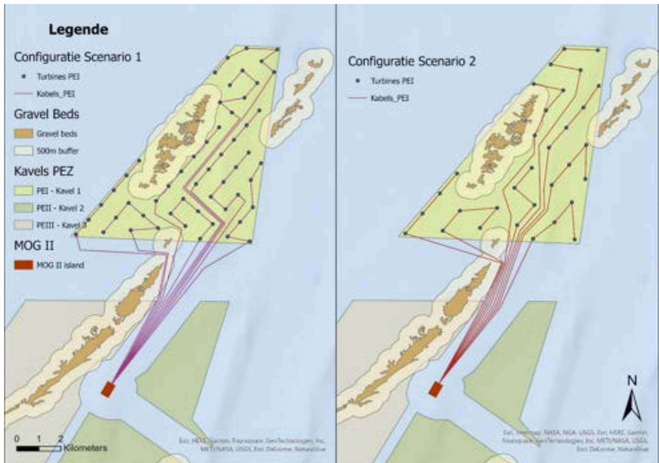
Figuur 4-1 – Indicatieve intekening van een concept-configuratie voor zowel turbines als parkbekabeling voor scenario 1 (linkerpaneel) en scenario 2 (rechterpaneel) in kavel PE I. Het MOG2 energie-eiland (rode rechthoek) en de grindbedden op basis van de laatste detailkarteringen (Monteale-Gavazzi et al., 2023a) in kader van het EDEN2000 onderzoek zijn eveneens mee aangeduid op de figuur.
