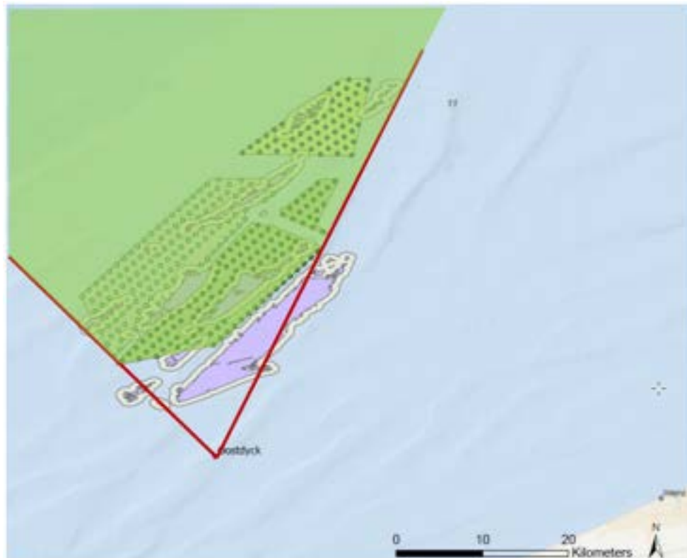
Figuur 5-86 – Dode zone achter het PEZ project voor de SRK radar van Oostende (Catrysse, 2023)
