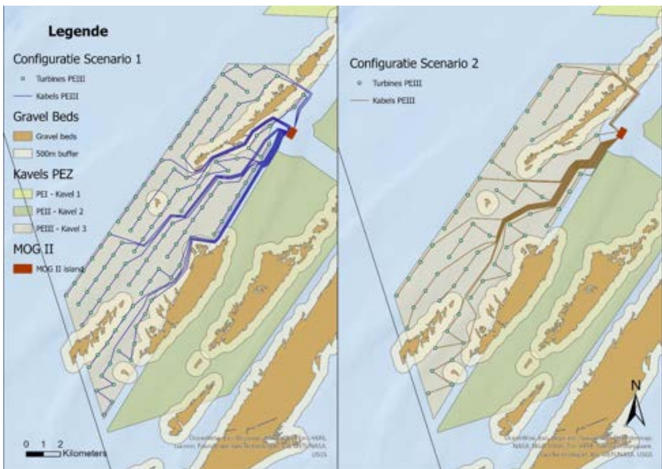
Figuur 4-3 – Indicatieve intekening van een concept-configuratie voor zowel turbines als parkbekabeling voor scenario 1 (linkerpaneel) en scenario 2 (rechterpaneel) in kavel PE II. Het MOG2 energie-eiland (rode rechthoek) en de grindbedden op basis van de laatste detailkarteringen (Monteale-Gavazzi et al., 2023a) in kader van het EDEN2000 onderzoek zijn eveneens mee aangeduid op de figuur.
