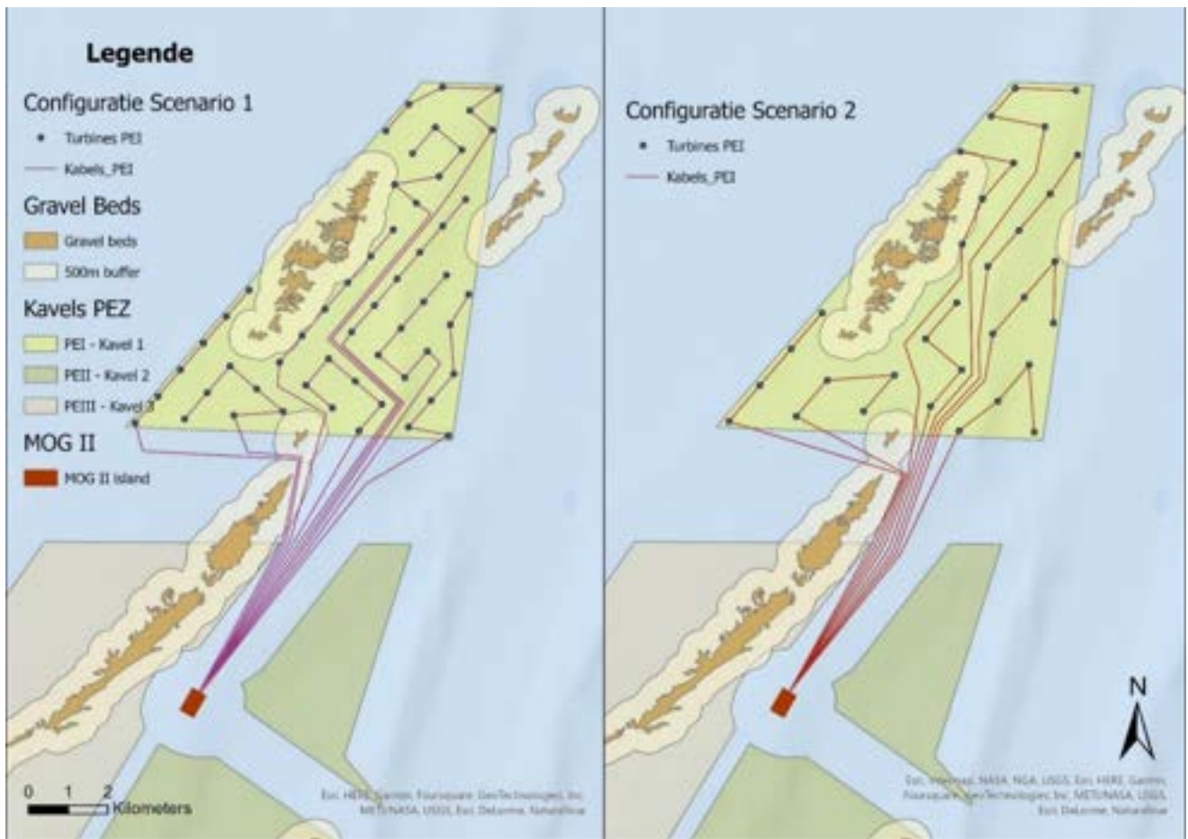
Figuur 7-2 – Indicatieve intekening van een concept-configuratie voor zowel turbines als parkbekabeling voor scenario 1 (linkerpaneel) en scenario 2 (rechterpaneel) in kavel PE I. Het MOG2 energie-eiland (rode rechthoek) en de grindbedden (inclusief 500 m bufferzone) op basis van de laatste detailkarteringen in kader van het EDEN2000 onderzoek zijn eveneens mee aangeduid op de figuur.
